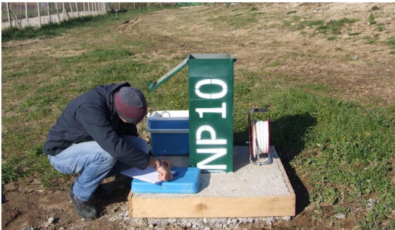
Si ricorda infine che attualmente la discarica è dotata sia di pozzi di monitoraggio che di piezometri. Si allegano foto delle attuali sistemazioni esterne utilizzate nella discarica e cioè i piezometri NP del Piano di caratterizzazione, i vecchi pozzi P di monitoraggio dell'invaso di discarica ( di cui alcuni ricadenti in area vincolata) ed i pozzi interni P(i) al polder per il controllo dei livelli interni al diaframma
